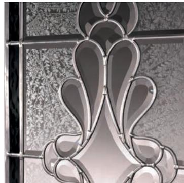
**Echte Bleiverglasung** besteht aus einzelnen Gläsern in unterschiedlichen Farben & Strukturen. Diese werden in Handarbeit mit Bleiprofilen eingefasst, zusammengefügt & die Kreuzungspunkte beidseitig sorgfältig verlötet. **Siehe z. B. Seite 96 Modell C1-038-01.**
